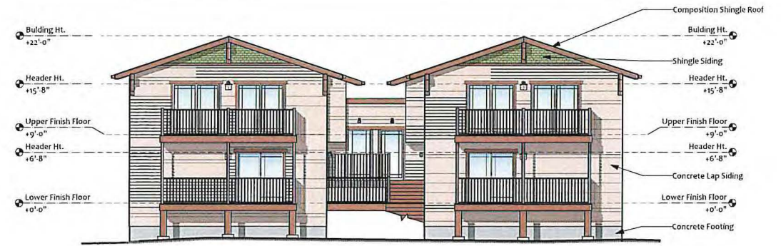
FRONT ELEVATION Scale: 1/8" = 1'-0"
