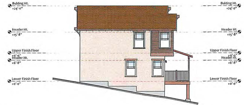
RIGHT ELEVATION Scale: 1/8" = 1'-0"
