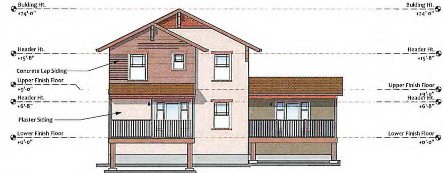
RIGHT ELEVATION Scale: 1/8" = 1'-0"
