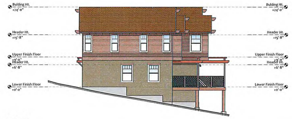
RIGHT ELEVATION Scale: 1/8" = 1'-0"
