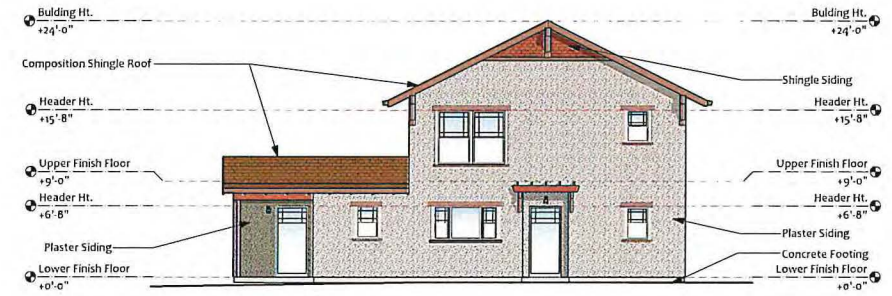
FRONT ELEVATION Scale: 1/8" = 1'-0"
